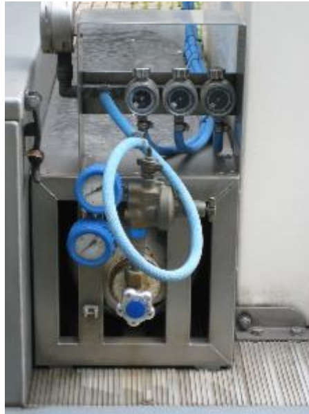
Abb. 4: Sauerstoffregleinheit mit Druckminderer und drei Stellventilen mit Durchflussmessern für die Behälter
