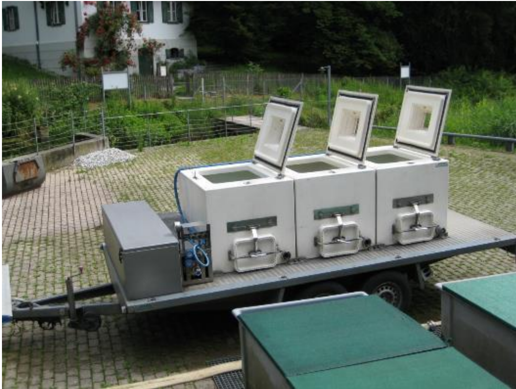
Abb. 3: Anhänger mit Transportbehältern mit Fischschleusen und installierter Sauerstoffzufuhr
