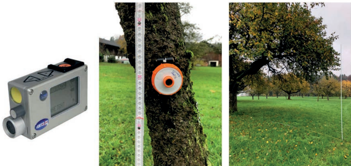
Abbildung 7: Messinstrumente für die Erhebung der Werte zur allometrischen Bestimmung der oberirdischen Gehölzbiomasse: Baumhöhenmesser Vertex IV (links), Transponder T3 (mittig), Messung der Baumkrone (rechts)
