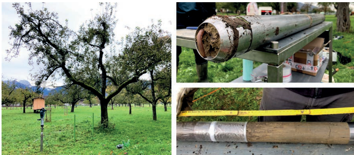
Abbildung 9: Anwendung des Beprobungsdesigns an einem Baum mit Rammkernsonde (links und rechts oben). Entnommener Bodenkern mit einer Mächtigkeit von 50 cm (rechts unten).
