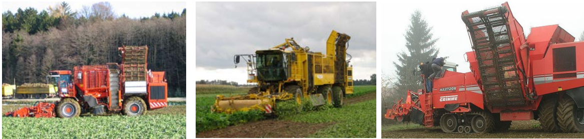
Fahrwerksvarianten von sechsreihigen Zuckerrüben-Köpf-Rode-Bunkern
