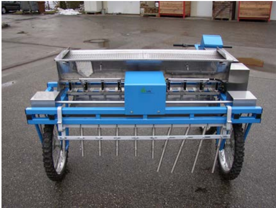
Handgeführter modular aufgebauter Parzellendüngerstreuer
