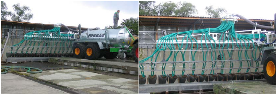
Prüfstand zur Ermittlung der Verteilgenauigkeit bodennaher Gülleausbringsysteme
