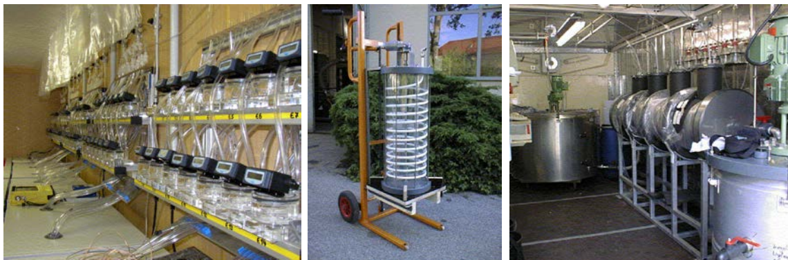
Einrichtungen zur Analyse anaerober Fermentationsprozesse: rechts: kontinuierliche Gasmengenerfassung, Mitte und links: verschiedene Laborfermentertypen
