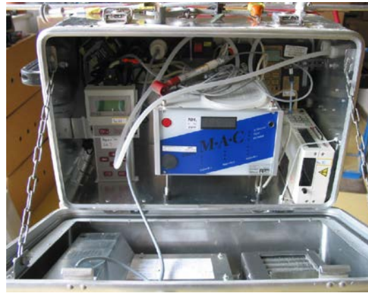
Klimatisierte Messbox für Staub- und NH 3 -Messung
