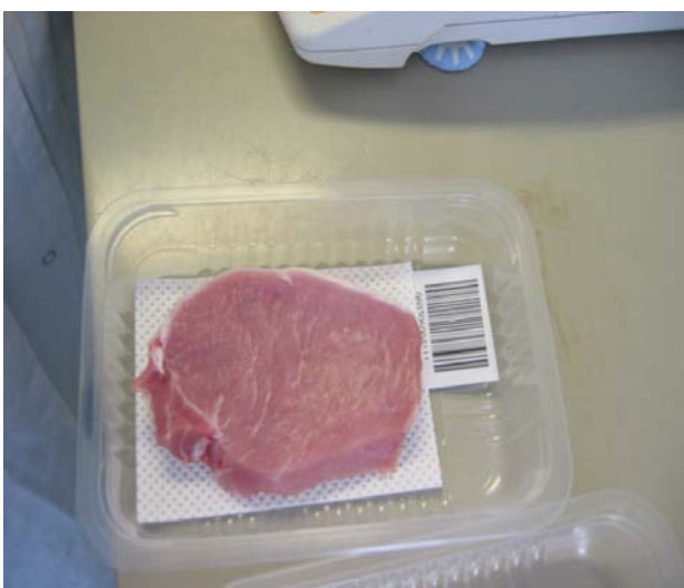
Abb. 13: Referenzmethode für die Tropfsaftbestimmung von Fleisch (Verpackung in Kunststoffschalen (links) und Versiegelung mit Traysealer (rechts)).
