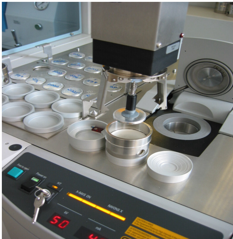
Abb. 5: Röntgenfluoreszenz-Spektrometer der Fa. Panalytical mit Probenpresse
