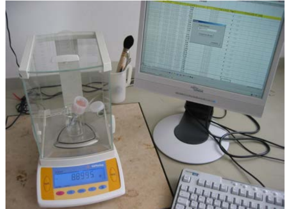
Abb. 14: Vereinfachte Methode (EZ-Methode) zur Bestimmung des Tropfsaftverlustes (links Ausstechen der Fleischzylinder, rechts Barcode-Erfassung und automatische Ein- und Rückwaage)
