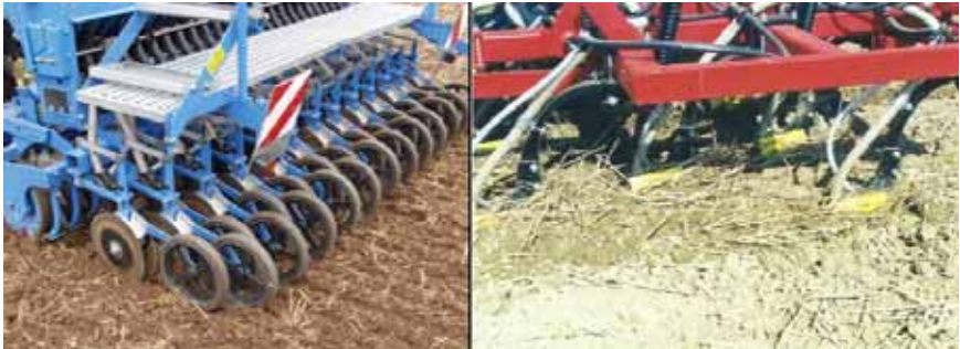
Scheibenschar mit Andruckrollen, für exakte Saatguteinbettung, Grubberschar mit Zuleitungen für Saatgut und Dünger
