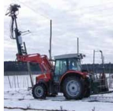
Graphische Darstellung der Ereignisse während der Durchführung eines Tests (links); Prototyp beim Aufhängen von Aufleitdrähten in einem Hopfengarten (rechts)
