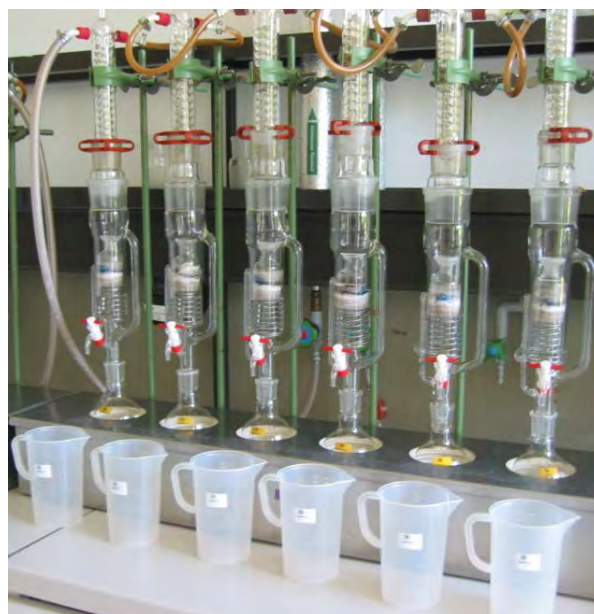
Abb. 55: Soxhlet-Extraktionsapparaturen für die Referenzanalytik. Die klassische Fettbestimmung dient der Absicherung der IMF-Untersuchung mittels NIRS
