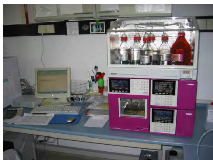
Abb. 63: Aminosäureanalysator zur quantitativen Bestimmung relevanter Aminosäuren in Futtermitteln
